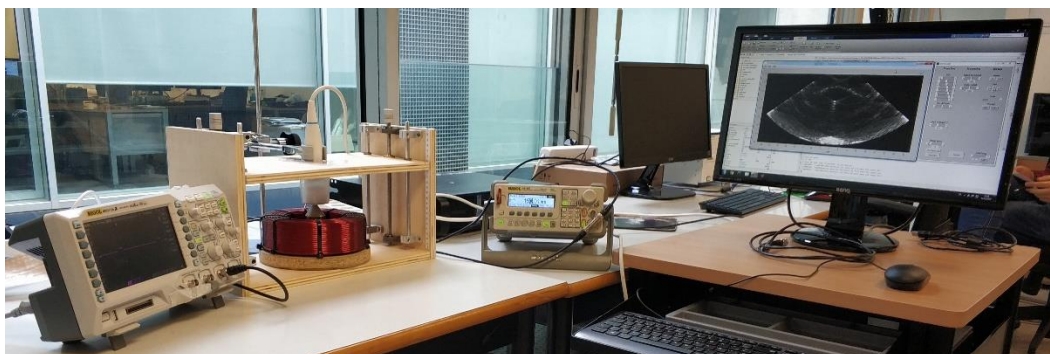
Dispositivo para el estudio de las propiedades viscoelásticas de los tejidos. CRÉDITO: I3M.
