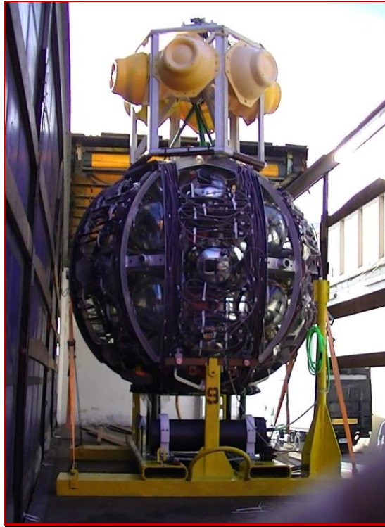
Imagen de la línea con los 18 módulos de detección enrollada. CRÉDITOS: Colaboración KM3NeT.
