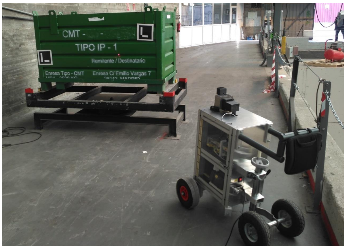
El dispositivo portátil GUALI permite mejorar la clasificación de los residuos nucleares. / Foto: IFIC
