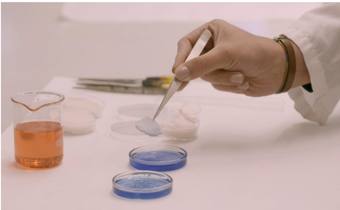
Demostración del comportamiento del aerogel en contacto con el agua. / CSIC Comunicación Comunidad Valenciana
