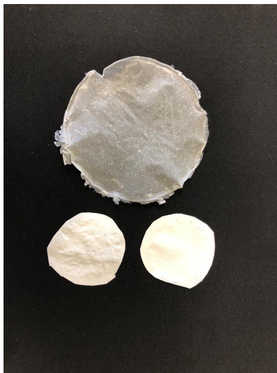
Films biodegradables preparados a partir de residuos de Posidonia oceánica . /CSIC
